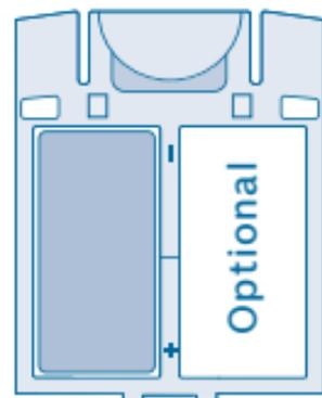
Batteriefach mit 1 Batterie
