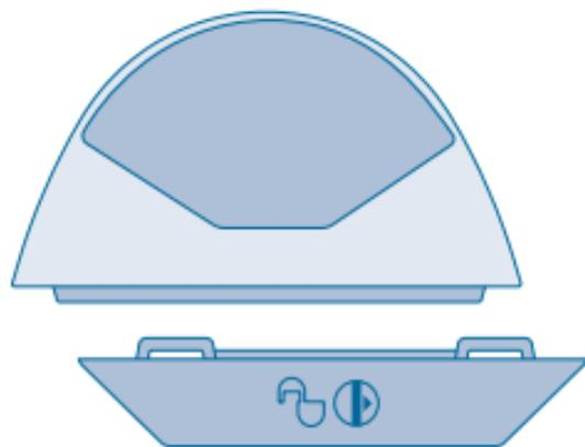
melders mit einem Schraubendreher um 180° gegen den Uhrzeigersinn und ziehen gleichzeitig das Gehäuse von der Halterung.
