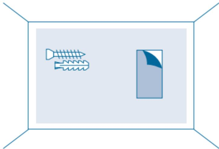
Der Bewegungsmelder kann in einer Ecke oder an der geraden Wand montiert werden. In beiden Fällen
