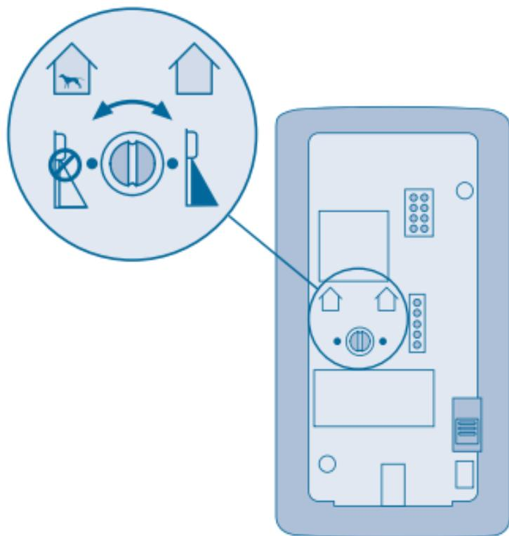
Ist die Haustiererkennung aktiv, werden Kleintiere (<25 kg) vom vorderen Sensor des Bewegungsmelders erkannt und ignoriert. Der nach unten gerichtete Sensor ist dann ausgeschaltet. Bei aktiver Haustiererkennung ist der Unterkriechschutz inaktiv!
