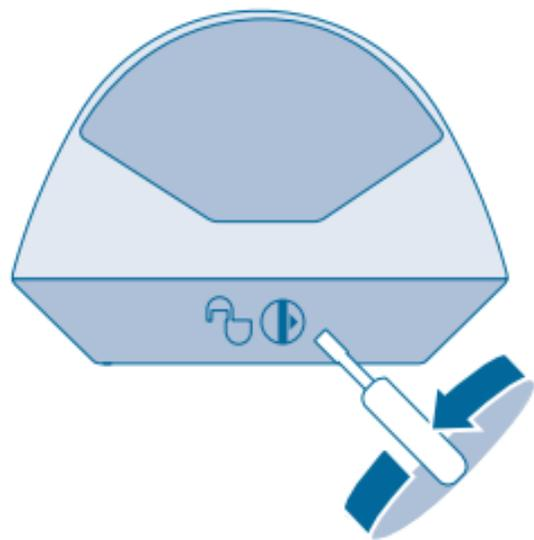
Trennen Sie das Gehäuse des Bewegungsmelders von der Halterung. Dazu stellen Sie den Drehverschluss an der Unterseite des Bewegungs-
