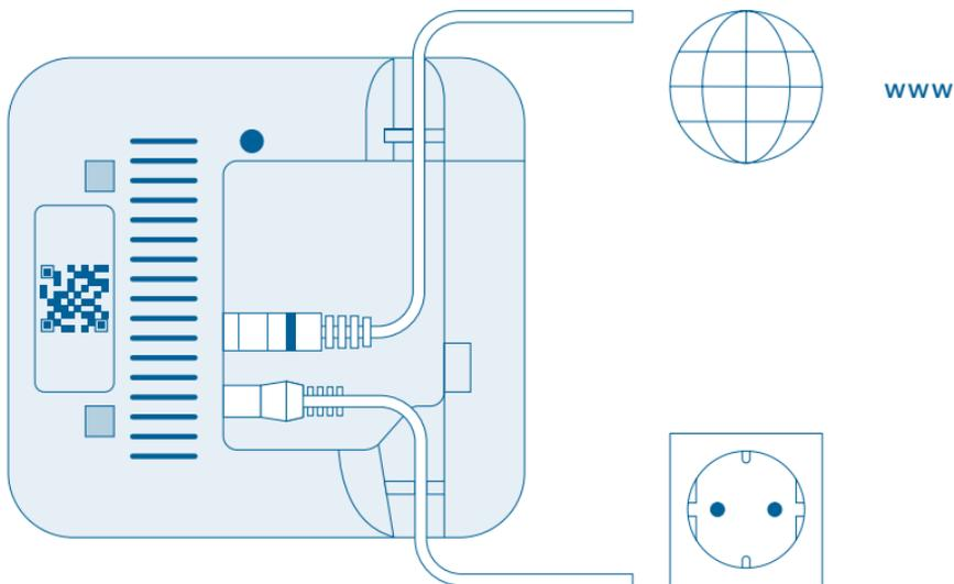
Stecken Sie das Netzwerkabel in den Controller und in einen freien LAN-Port an Ihrem WLAN-Router. Verbinden Sie nun den Controller über das Steckernetzteil mit der Steckdose.
