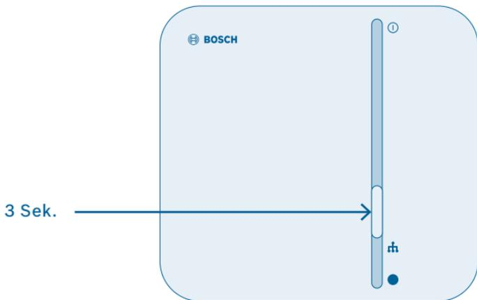
Als nächstes wird Sie die App auffordern, die Funktionstaste am Controller für etwa 3 Sekunden zu drücken.
